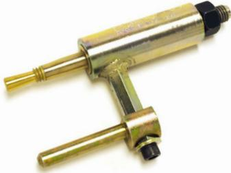
Permite instalaciones fiables en aquellos casos en los que no haya disponible aire o electricidad. Cada herramienta de instalación manual incluye una varilla de tracción y un posicionador para instalar el sello de tubo Pop-A-Plug con el tamaño y el estilo identificados en el número de modelo de la herramienta. La herramienta de instalación manual se puede usar con llaves de tuerca o de tubo, así como con llaves de impacto eléctricas o neumáticas.
