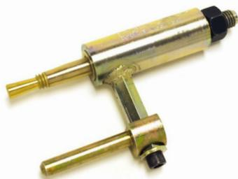
Permet une installation fiable lorsqu'il n'y a pas d'air ni d'électricité disponible. Chaque outil d'installation manuelle est fourni avec une tige de traction et un positionneur pour installer l'obturateur de tube Pop-A-Plug de la taille et du type identifiés dans la référence de l'outil. L'outil d'installation manuelle peut être utilisé avec des clés ou des douilles manuelles, ainsi qu'avec des clés à chocs électriques ou pneumatiques.
