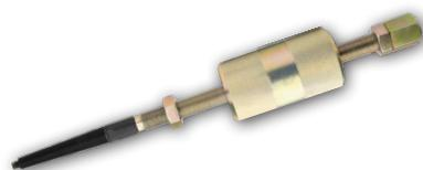
Extrayez rapidement les obturateurs de tube Pop-A-Plug installés avec l'outil d'extraction d'obturateurs à double fonction. Comprend un bec qui se visse dans la goupille d'un obturateur installé, ce qui permet de séparer la goupille de la bague. L'outil maintient la goupille tandis qu'une lance dentelée agrippe le DI de la bague. Le marteau coulissant intégré extrait la bague et la goupille d'un seul coup. Également disponible en modèles à rallonge.
