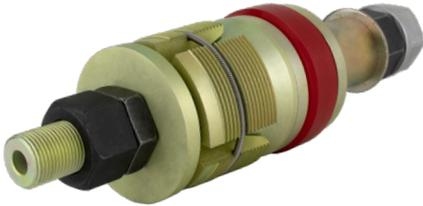
Druckprüfung der Flansch-Rohr-Schweißnähte mit vollen Radial-, Umfangs- und Axialspannungen – äquivalent zu den Spannungen, die entstehen würden, wenn eine Blende verwendet würde, um das gesamte Rohrleitungssystem unter Druck zu setzen. Durch die Druckprüfung kann die Schweißnaht zu 100% wirksam überprüft werden und dem Benutzer das Vertrauen vermitteln, dass der Flansch und die Schweißnaht bei der Inbetriebnahme korrekt funktionieren.
